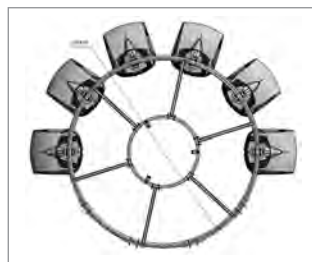
Параметры короны на 6 прожекторов с асимметр. расположением прожекторов со встр. ПРА
