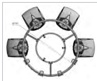
Параметры короны на 4 прожектора с асимметр. расположением ПРА
