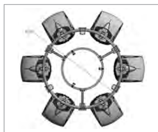
Параметры короны на 6 прожекторов с симметр. расположением ПРА
