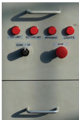
Управлять мачтой можно локально или с пульта дистанционного управления
